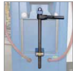
VERSTELLEINRICHTUNG mit Ratsche zur Höhen- verstellung der unteren Armatur
