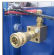
SCHNELLKUPPLUNG Wasseranschluss für Schweißwerkzeuge
