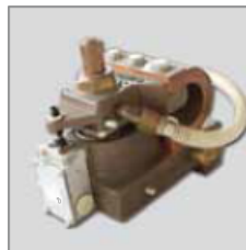
FOLGEELEKTRODENHALTER (für besseres Nachsetzverhalten der Elektrode)
