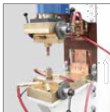
SCHNELLWECHSEL-SYSTEM für schnellen Werkzeugwechsel
