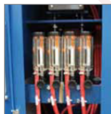
WASSERDURCHFLUSS- KONTROLLE 4-fach
